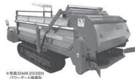
軟弱地での作業に威力を発揮する大型自走式マニアスプレッダ
